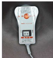
ランプが消えたら充電完了。強・弱モードの切り替え機能付き
