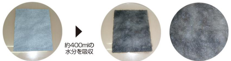
吸水シート吸水試験
