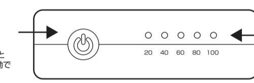
リチウムイオンバッテリーは、過放電させると著しく寿命を縮めるばかりではなく、化学反応により内部が不安定な状態になります。電池残量がゼロになった場合は、3日以内に充電してください。また、長時間使用しない場合には自然放電により残量が少しづつ減少しますので、約3か月に1度は定期的に充電してください。
